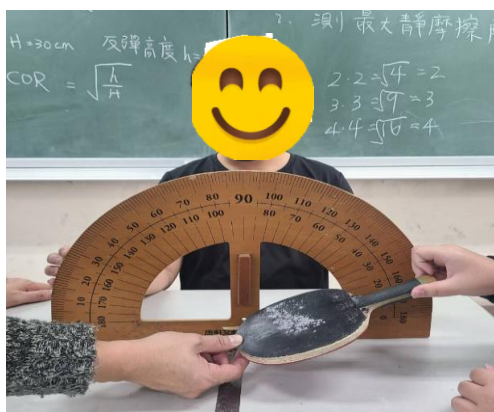
圖 5：將爽身粉均勻撒於膠皮表面，隨後輕拍兩下除去鬆散粉末，模擬長期未清潔的狀態。
