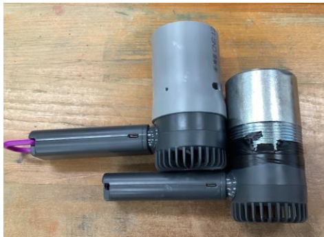
圖(20)裝設 PVC 管、鐵管的風扇
