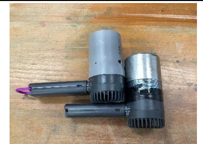
風扇加 PVC 管、鐵管
