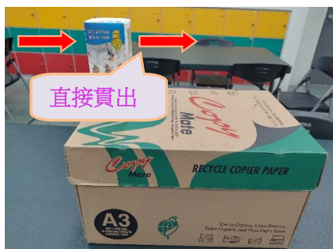
圖 4-2-1-3 單塔對開型式(開口 AC)，風可能直接貫出(自行拍攝)
