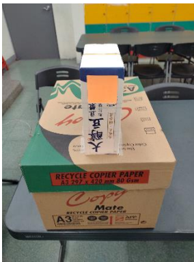
圖 3-2-3 以牛奶盒模擬捕風塔，將它插入紙箱蓋子缺口處，並以隱形膠帶黏貼接縫處，防止溫度的散失(自行拍攝)
