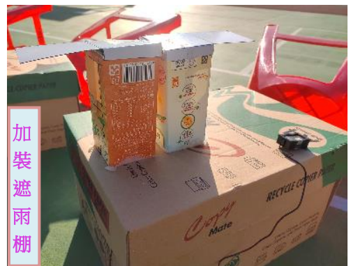
圖 5-2-1 捕風塔上加裝遮雨棚，戶外實測 30 分鐘(自行拍攝)
