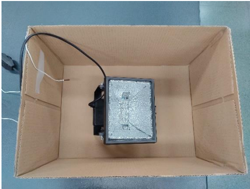
圖 3-2-1 以紙箱模擬房屋室內空間，將探照燈放置於 A3 紙箱 (42*29.7*24cm)，並將溫度感測器測溫探頭用膠帶貼於紙箱內(自行拍攝)
