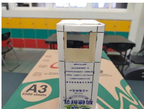
圖 4-2-1-3 單塔對開型式(開口 AC)，風可能直接貫出(自行拍攝)
