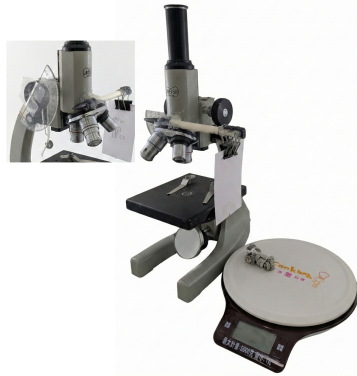
圖 2. 改裝式顯微鏡與電子秤。（本圖由作者拍攝）
