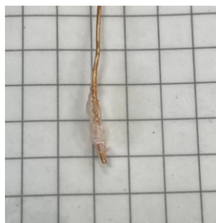
圖六：以熱溶膠封住負極金屬，留下末端
