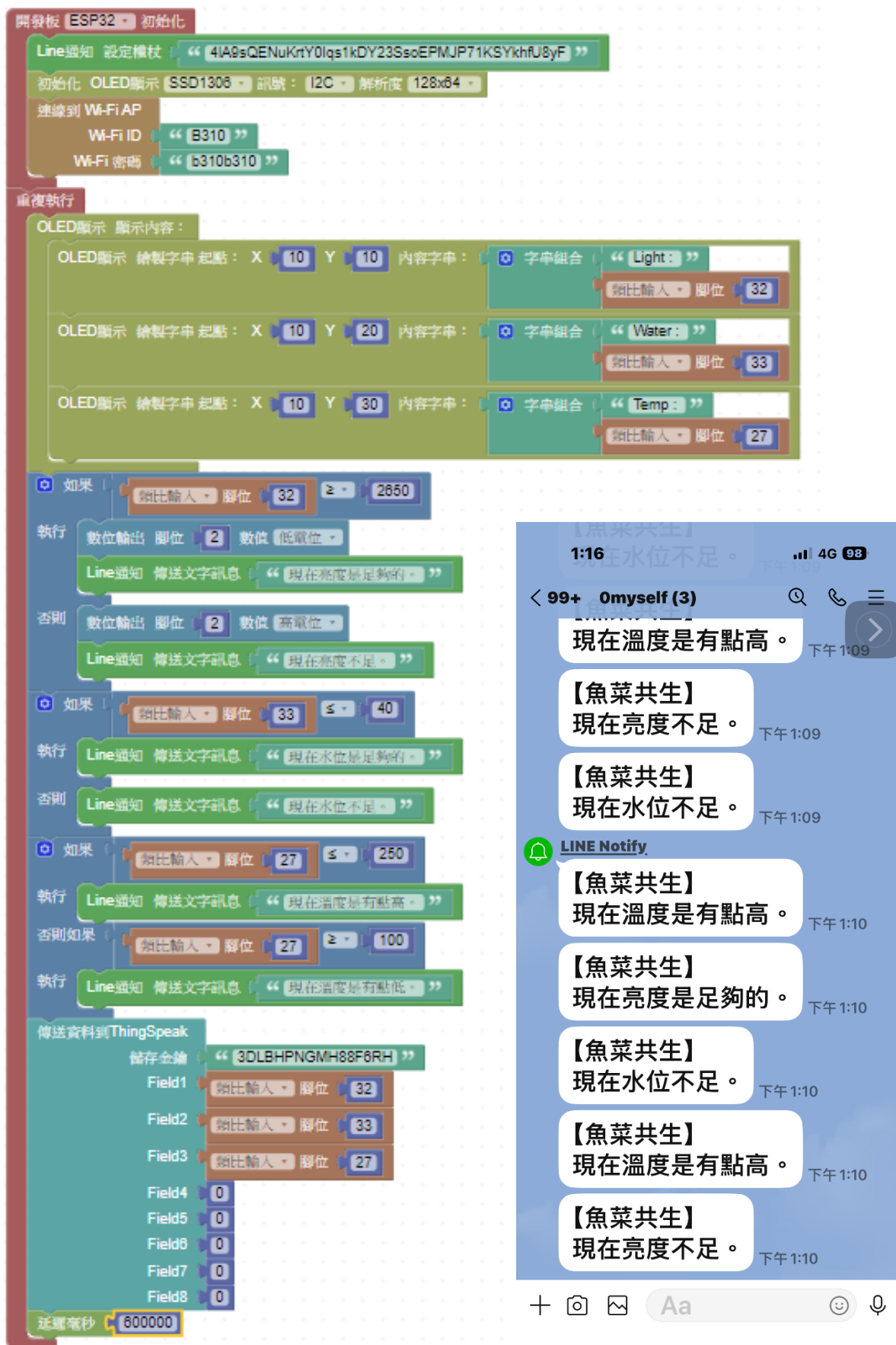
圖 19. BlocklyDuino 程式碼與 LineNotify 通知。
