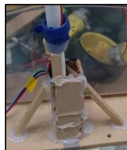
(圖 4-19)減少伸縮桿和固定座之間的空隙 (自行拍照)
