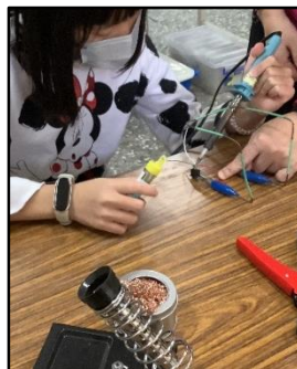
(圖 4-4) 焊接開關電線 (自行拍照)
