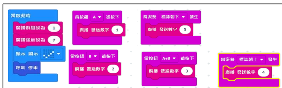
(圖 2-11)發射端 micro:bit 程式積木（自行截圖）
