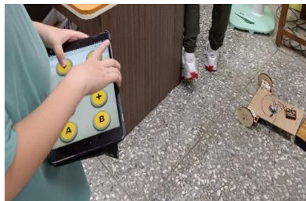
(圖 1-2)使用平板遙控小車 (自行拍攝)
