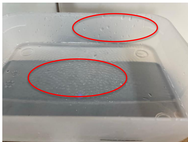
圖三十一 振動頻率90分貝，底液濃度2%，水面濺起水花 [自行拍攝]
