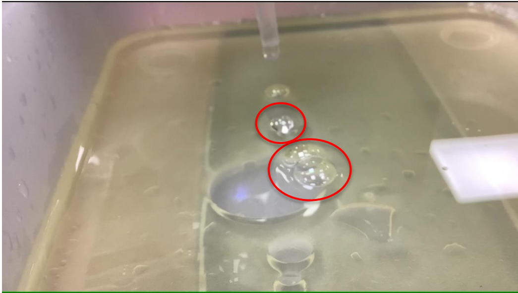
圖三十四 振動頻率140Hz，音量70分貝，沙拉油幾乎無法形成法拉第波 [自行拍攝]
