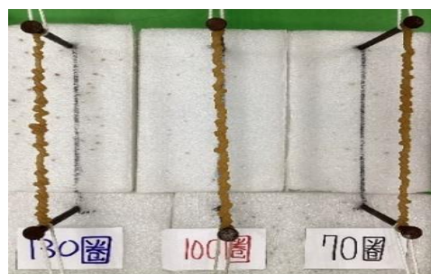
圖 3-3 橡皮筋扭轉 n 圈後拉長 13 公分的形狀。 圈數越多橡皮筋扭曲越密集，線條也越不平整。
