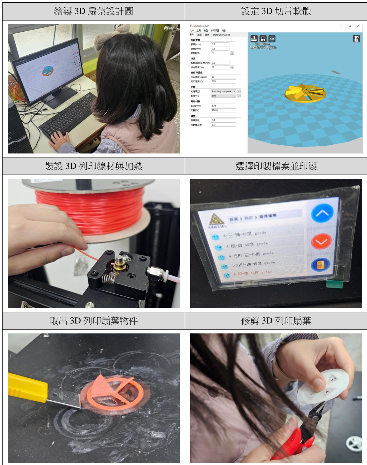
圖 3-4-2 TinkerCad 繪製 3D 列印扇葉與印製過程圖(自行拍攝)
