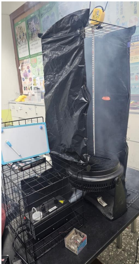
圖 3-4-3 煙霧器與循環扇風向測試裝置圖
