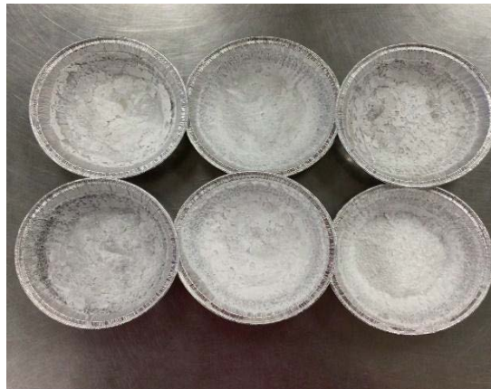
圖 12：1.7g 石灰粉/1L 水石灰水水漬生成圖
