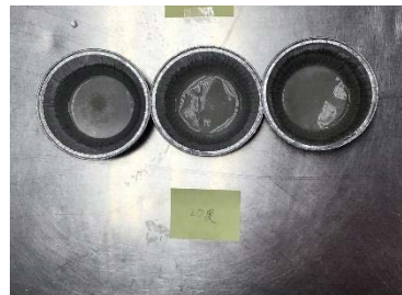
圖 15：清潔後的水漬圖（40 度）
