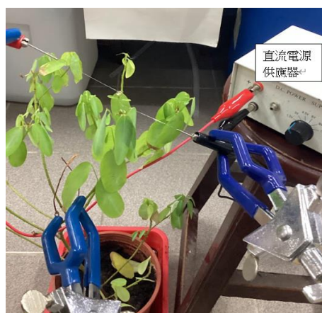
(圖 3-1-6) 電擊實驗的裝置
