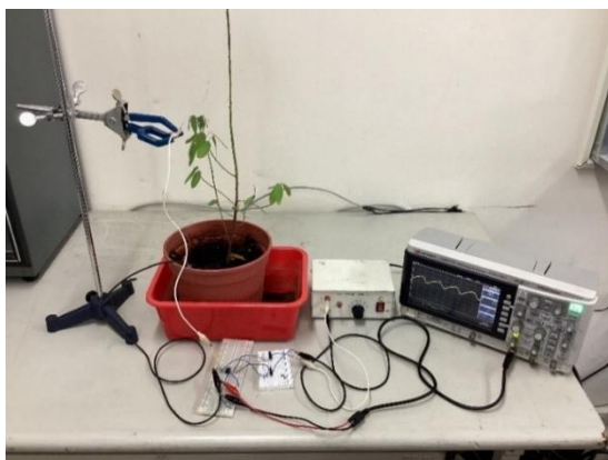
(圖3-1-10) 自製植物電壓感測器連接跳舞草
