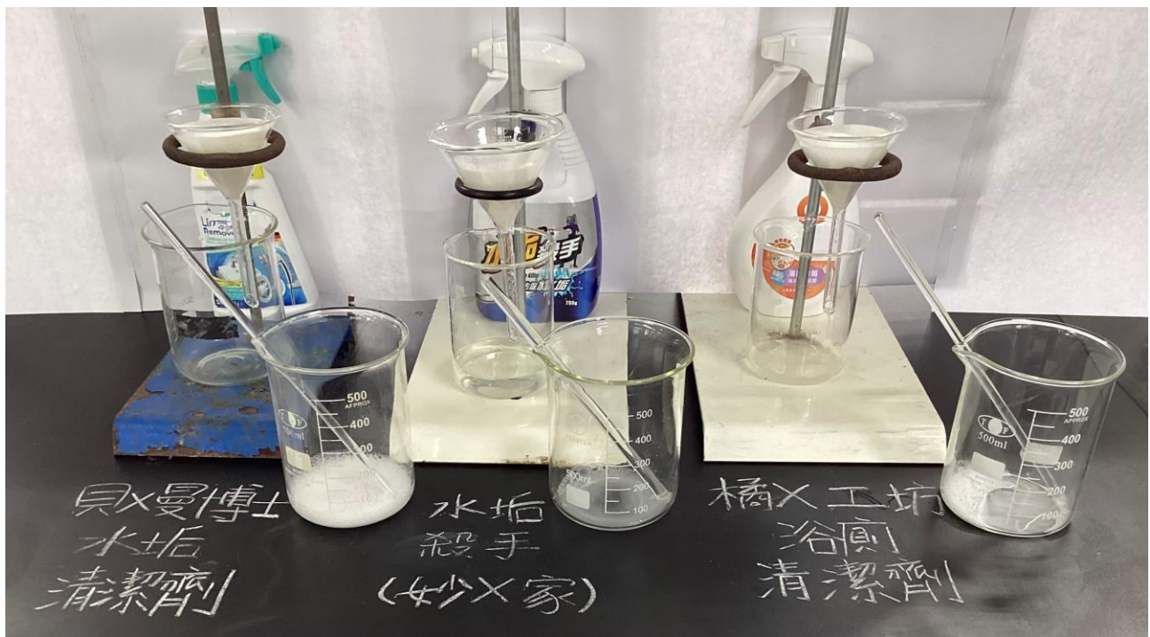
圖2、不同的市面清潔劑對水垢清潔效果的影響實驗過程
