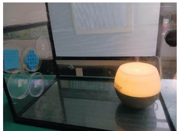
圖六 模板黏放於觀察箱加濕器開啟運作圖
