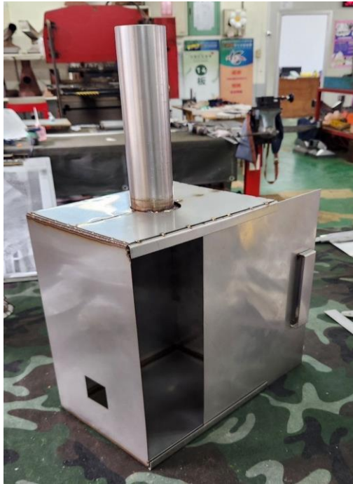
圖三 自製有煙囪的隔風不鏽鋼箱 (上方設計有煙囪，兩側面的下方有進氣口)
