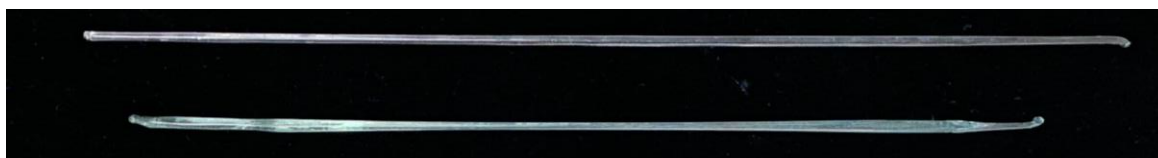
圖一實驗所用玻璃珠燒熔再拉長有許多空氣在裡面
