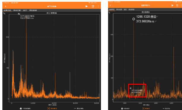
圖五灰管甲管在風速 9.4（m/s）下所發出聲音頻率 Phyphox 截圖
