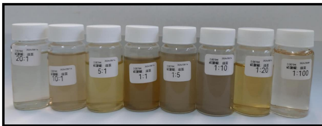
圖八 以 365 nm 的紫外光照射硝酸銀與綠茶萃取液混合的溶液，照片依樣品編號順序從左至右 T1~T8。
