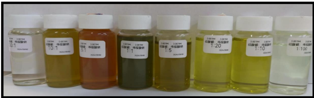
圖六 以 365 nm 的紫外光照射硝酸銀與檸檬酸鈉混合的溶液，照片依樣品編號順序從左至右 #4~#11。
