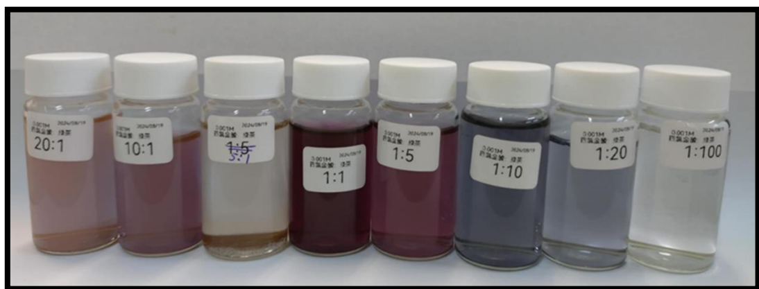
圖十二 以 365 nm 的紫外光照射四氯金酸與綠茶萃取液混合的溶液，照片依樣品編號順序從左至右 G1~G8。
