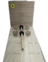
(4)磁鐵左右距離越近，磁力越大，筆浮的垂直高度越高，磁鐵左右距離越遠，磁力越小，筆浮的垂直高處越低，甚至可能無法懸浮，所以我們選擇 1 號裝置(底盤磁鐵左右距離為 1.5cm)為後續研究的標準。
