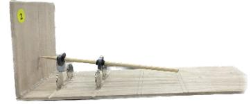
(2)筆上的磁鐵位置要對應底盤的磁鐵，但筆上的前磁鐵位置要比底盤磁鐵位置前面一點點會更容易達到平衡。
