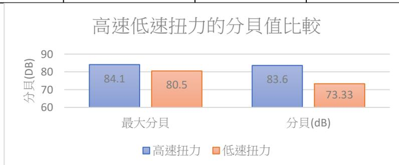
由上圖可知，以電鑽在木板上進行高速與低速鑽洞模擬施工常見的動作，發現電鑽為最高速達每分鐘最高 3000 轉和低速運轉比較，最大分貝值和 4000Hz 附近的分貝值均為高速運轉大於低速運轉，達分貝值在 84dB 以下，而低速運轉有時達 73 分貝左右。
