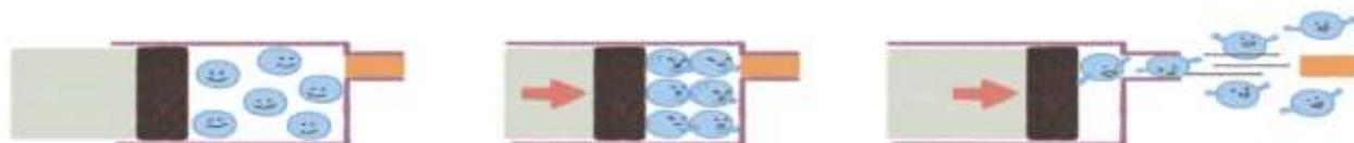
圖三 空氣可以被壓縮後傳送動力
