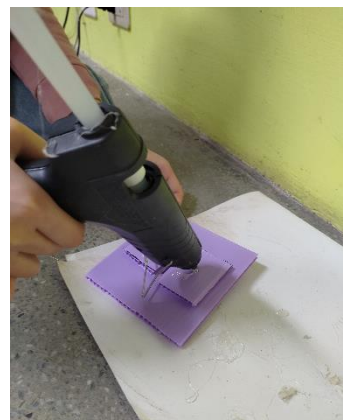
圖 3-1-12 再用熱熔膠黏在螺絲尖端，以免操作時手被割傷
