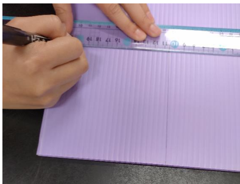
圖 3-1-1 將塑膠瓦楞板裁切成 12*12cm 的正方形
