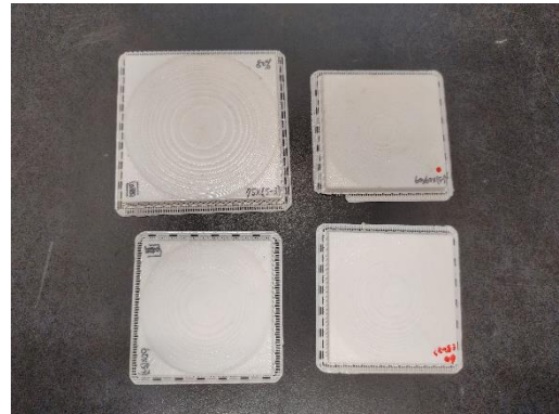
圖 2-6 3D 凹槽轉板(弧面、拋物面)
