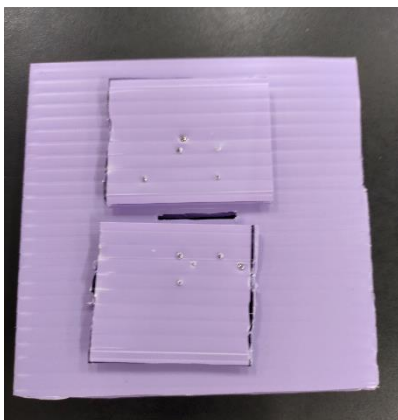
圖 3-1-11 投幣板背面螺絲突出尖銳，用瓦楞板覆蓋住
