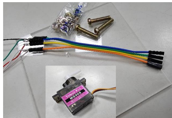
圖 2-10 螺絲 M4*20mm、杜邦線 壓克力板、MG90S 伺服馬達
