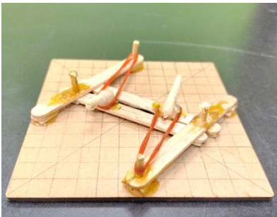
圖 5-2-1 夾棍合起 → 投幣後錢幣撐開夾棍 → 橡皮筋也會被拉開
