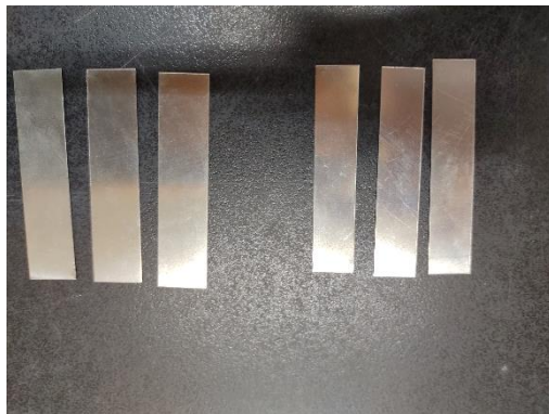
圖 2-3 不鏽鋼彈片—5*40*0.3mm 10*50*0.3mm
