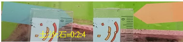
圖 4.15 抽取地下水後，右側對照組(橘)pvc板，小石支撐力較小，明顯會低於原始位置。
