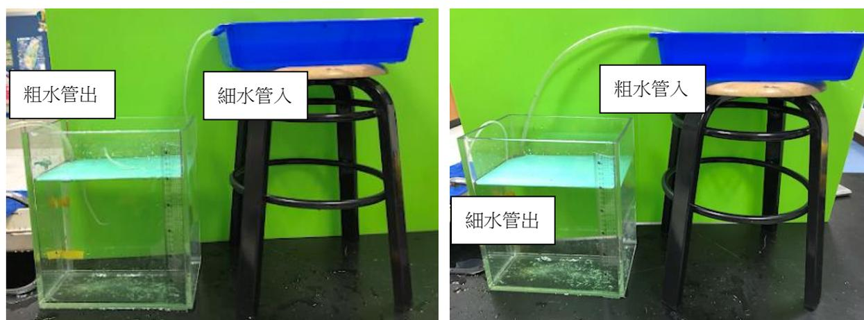
圖 4.5 實驗三不同粗細水管注水及取水裝置圖
