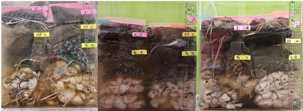
圖 4.9 不同地質比例的實驗裝置圖(從左起：土 2+沙 4、土 2+石 4、土 4+石 2)
