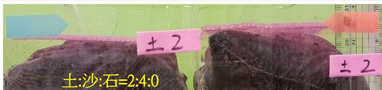
圖 4.12 抽取地下水後，左側實驗組(藍)pvc 板明顯會低於原始位置。
