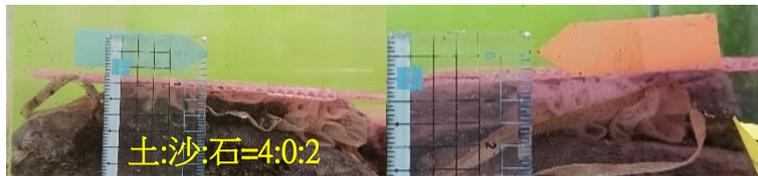
圖 4.11 抽取地下水後，左側實驗組(藍)pvc 板下降程度反而會大於右側實驗組(橘)。
