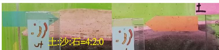
圖 4.13 抽取地下水後，左側實驗組(藍)pvc 板明顯會低於原始位置。
