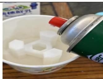
圖 4-57 灌模容器內部及模型原型噴離型劑。
