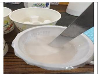
圖 4-59 調和後，要盡速攪拌均勻，防止固化。
