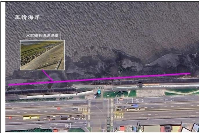
圖 5-7 風情海岸無消波塊，有水泥邊坡堤岸。
