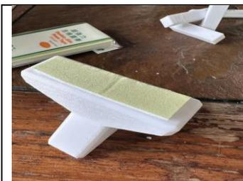
圖 4-56 模具底部貼雙面泡棉膠，防止模具浮起來。
