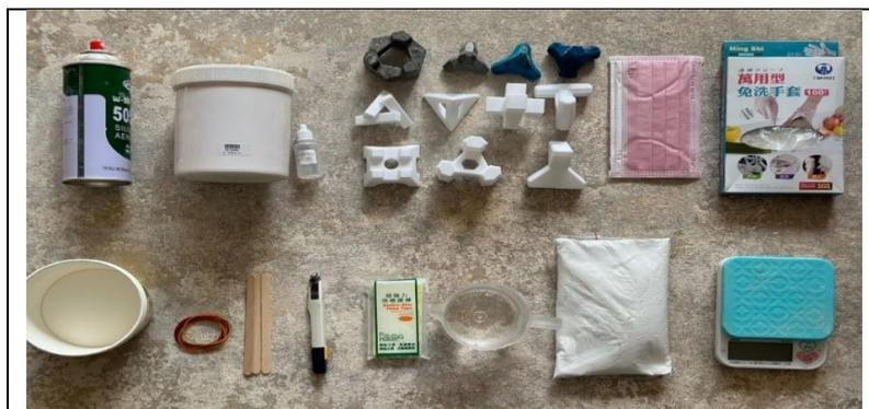
圖 4-55：離型劑，矽膠，3D 列印消波塊模型，口罩，免洗手套，紙盒、橡皮筋、冰棒棍、美工刀、泡棉膠、量杯、石膏粉、磅秤
