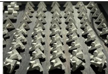
圖 5-10 消波塊模型晾乾
