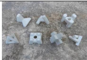
圖 4-49 用 3D 列印的消波塊模型
