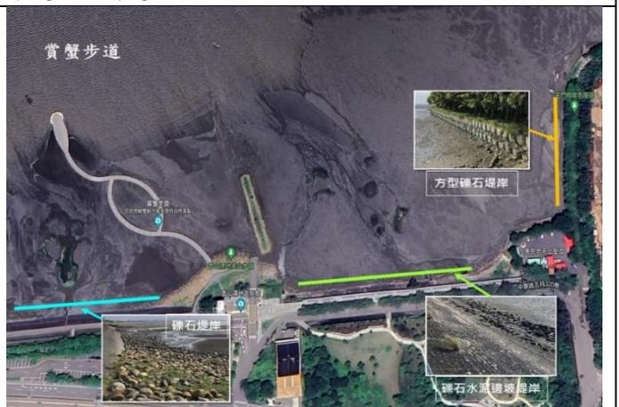
圖 5-6 賞蟹步道無消波塊分佈，北岸有方形礫石堆疊起來的堤岸，南邊則是礫石疊成的堤岸和水泥礫石堤岸。
