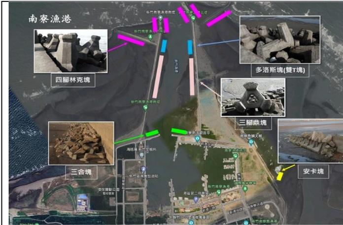
圖 5-1 南寮漁港共五種消波塊：四腳林克塊、雙 T 塊、三腳鼎塊、三和塊及安卡塊。
