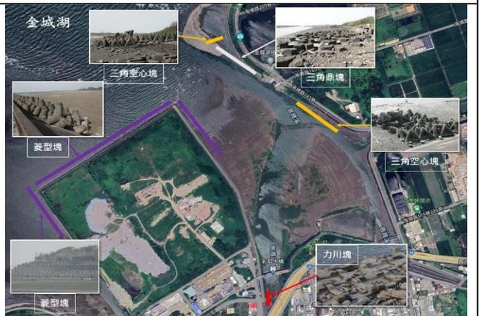
圖 5-4 金城湖共四種消波塊：三角空心塊、三腳鼎塊、菱形塊、力川塊。
