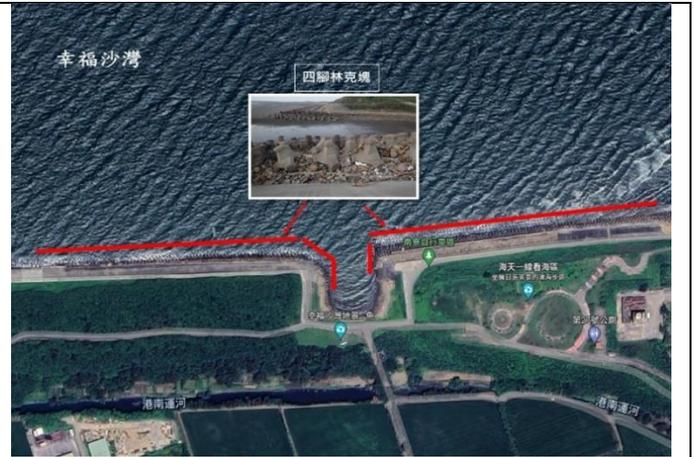
圖 5-2 幸福沙灣只有一種消波塊：四腳林克塊及礫石堆疊成的堤防。
