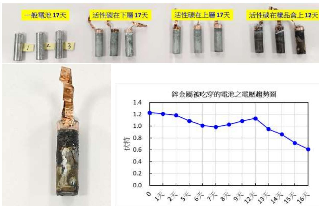
圖五、鋅金屬被吃穿電池的電壓趨勢圖
