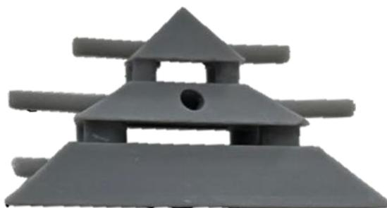
圖 16、卡榫設計的 3D 列印 flow cell
