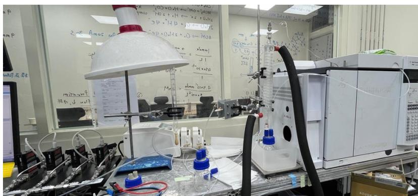
圖 8、利用 flow cell 測試產物裝置圖
