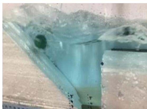
△ 圖 5-4、5 三角形障礙物測量漩渦拉力實際影像
