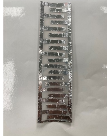
圖 14 水龍頭漏水實測實驗 銀箔砂紙間距小間隔 0.3 公分
