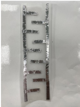
圖 12 水龍頭漏水實測實驗 銀箔砂紙間距大 間隔 1 公分
