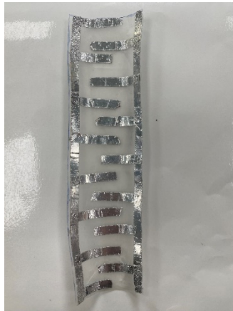
圖 13 水龍頭漏水實測實驗 銀箔砂紙間距中 間隔 0.5 公分
