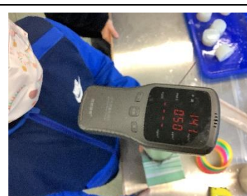
圖中我們用 pm2.5 偵測器測量棉花的防煙效果
