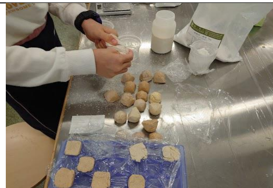
煮軟後的口香糖與滑石粉、碳酸鈣、石灰粉、石膏粉、松香等粉末混合的過程，混完粉放入模具中。
