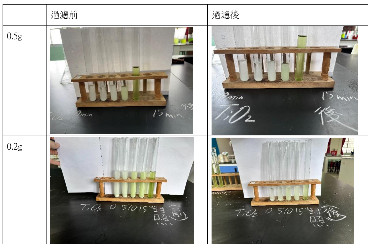
圖十五 不同質量，加入碳粉後過濾效果
