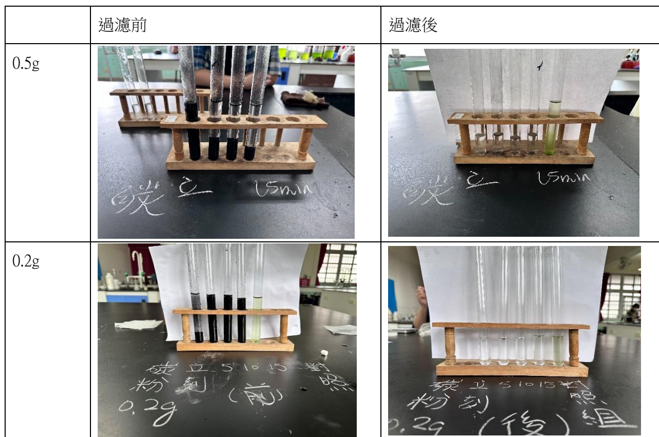
圖十四 不同質量，加入碳粉後過濾效果
