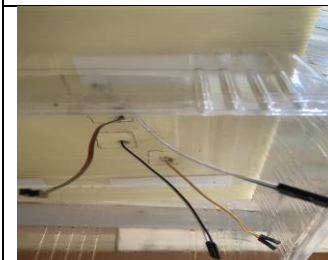
圖 4-109 使用利器在石膏上挖洞，埋入電線、裝入 LED 燈
