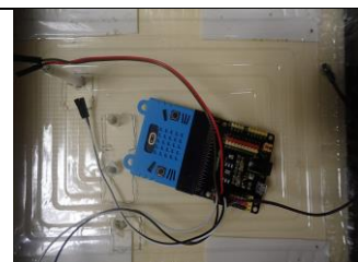
圖 4-114 把 LED 燈下的接頭連接 microbit
