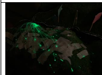
圖 4-113 在剛才弄的 LED 燈上面接上光纖
