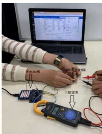
圖 12：光敏電阻測試實驗裝置圖
