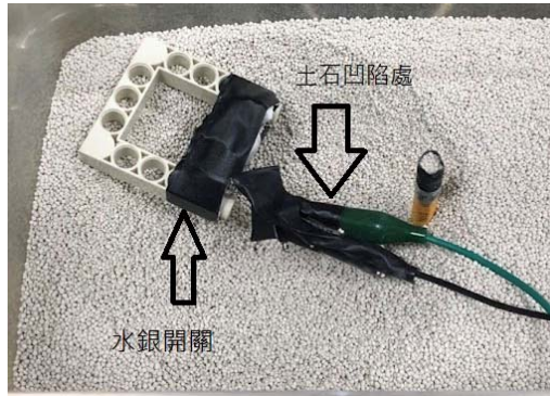
圖 7：土石滑動造成水銀開關傾斜
