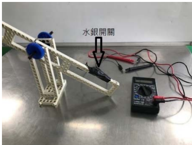
圖 1：水銀開關測試實驗裝置圖
