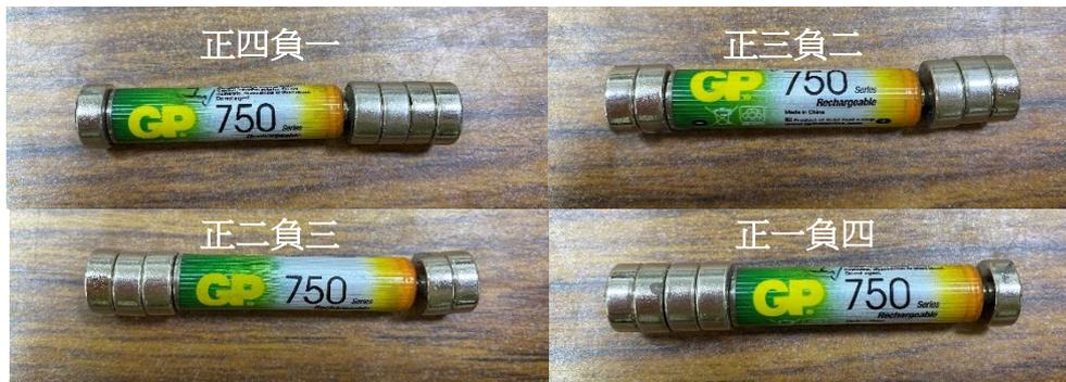
圖八 磁鐵位置擺放不同的磁浮列車
