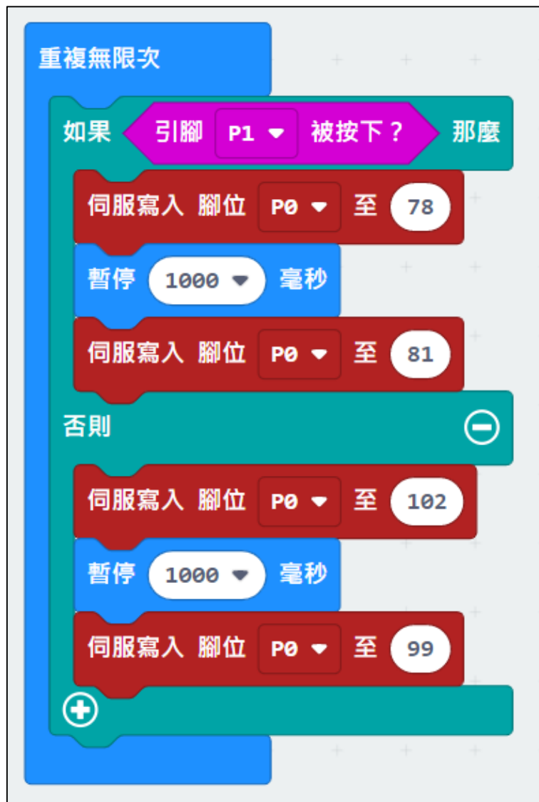
圖 4-2-4 物體人體紅外線感測設備控制 SG 單切馬達操控單切開關之程式設計圖(Micro:bit)
