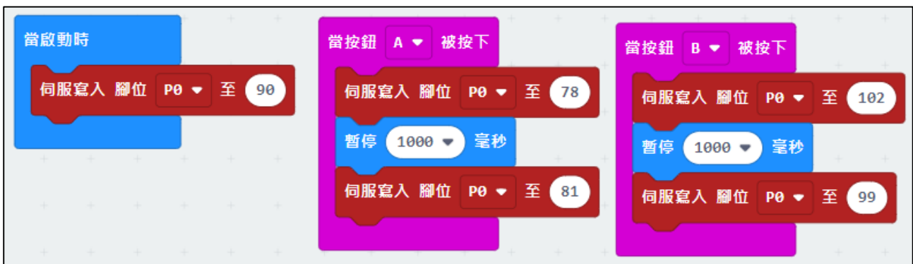
圖 4-1-1 SG90 伺服馬達操控單切開關之程式設計(micro:bit)
