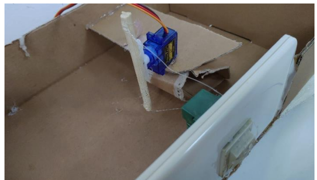
圖 5-3-5 隱藏式開關裝置加長型轉軸
