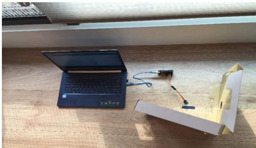
圖23 將照度感應器以隨意貼固定在實驗位置上，確認當下照度
