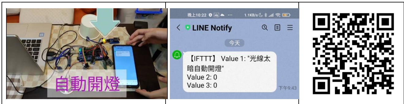
圖 5-18 光線感測器亮度測試和自動開燈實驗
