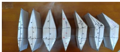
名稱：人體仿真模型 功能：模仿人體腳擺動振幅的模型，放置於風洞中觀察尾端渦流現象
