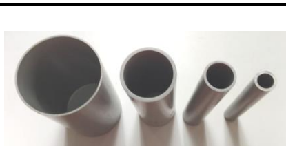
名稱：不同直徑的水管 功能：放置於風洞中觀察渦流現象
