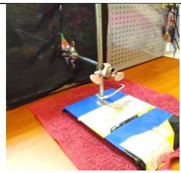
名稱：固定架 功能：將待測物體固定在流場
