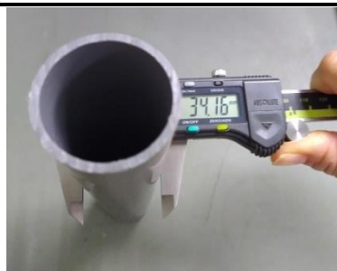
名稱：游標卡尺 功能：量測待測物體直徑
