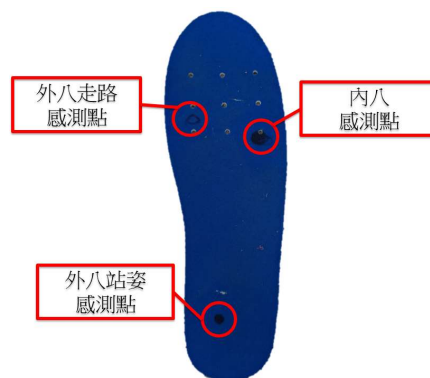
(圖八) 各感測點鞋墊位置
