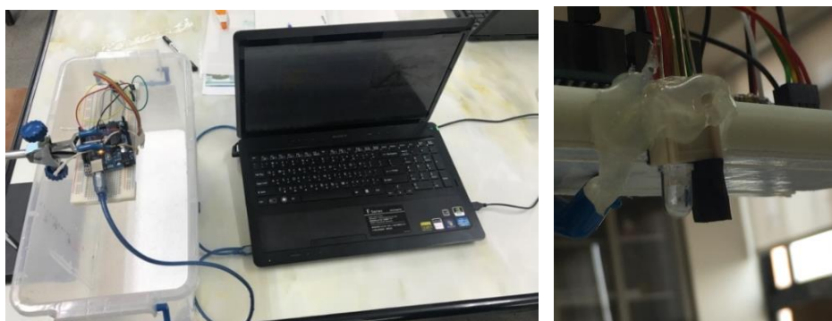
圖 8 (左) 利用紅外線訊號接收強度偵測水位高度系統實體圖 (右) 於紅外線接收器外加上黑色光罩可減少環境紅外線影響
