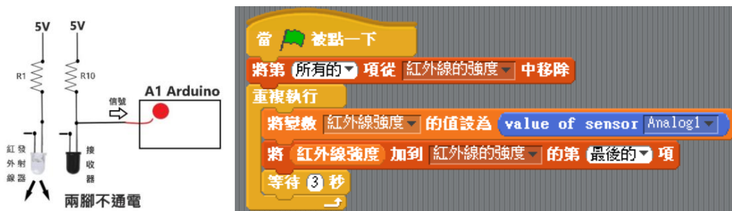
圖 7 (左) 紅外線訊號偵測電路設計示意圖 (右) 偵測紅外線強度之程式
