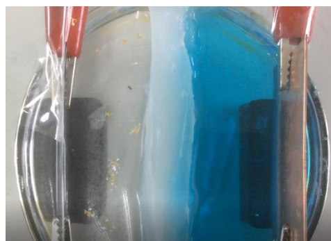
(圖 5-1)磁場方向(負極 S↑, 正極 N↑)1000G
